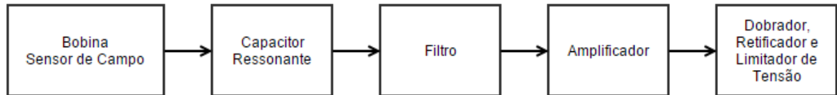
Figura 10 - Diagrama de blocos do conjunto de sensor e circuito de captação do campo magnético Fonte: Autoria própria
