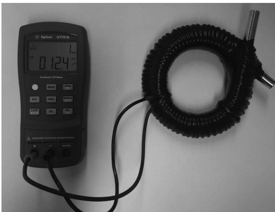
Figura 22 – Ponte RLC medindo o indutor Fonte: Autoria própria (2015).
