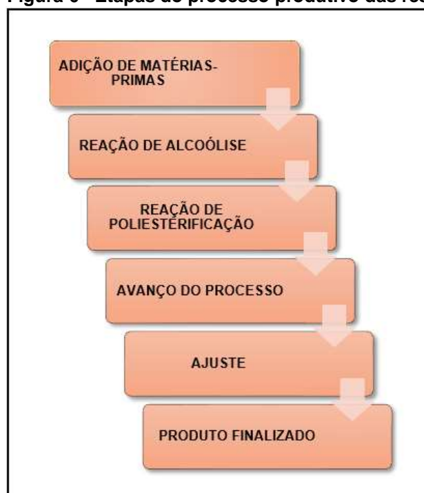
Figura 6 - Etapas do processo produtivo das resinas alquídicas
