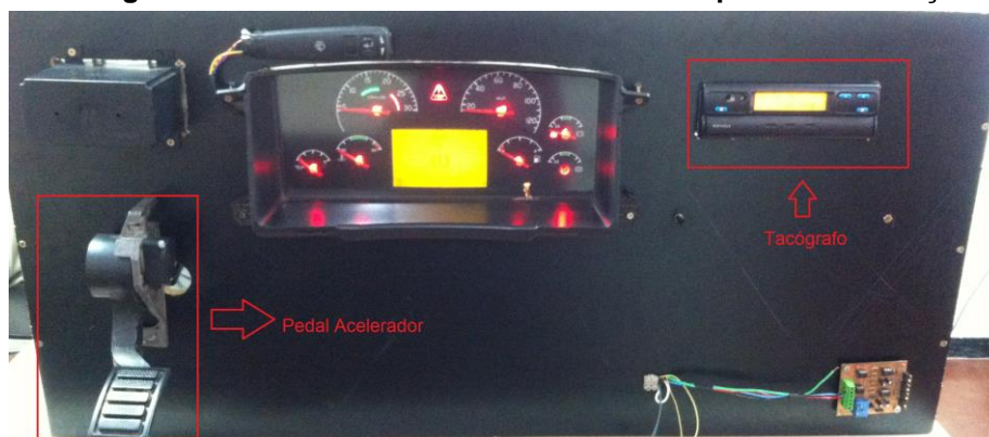
Figura 23 - Bancada de Laboratório Utilizada para Comunicação de Dados
