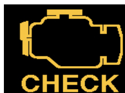
Figura 13 - Lâmpada Indicadora de Mau Funcionamento (MIL)
