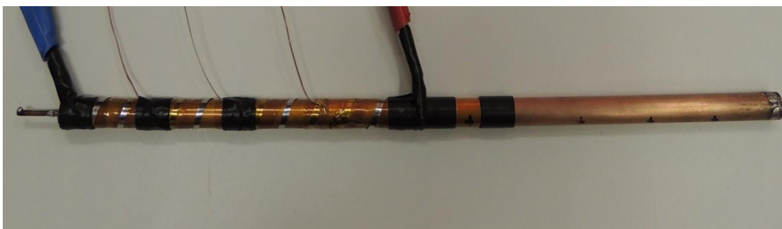
Fotografia 8 - Posição do resistor elétrico
