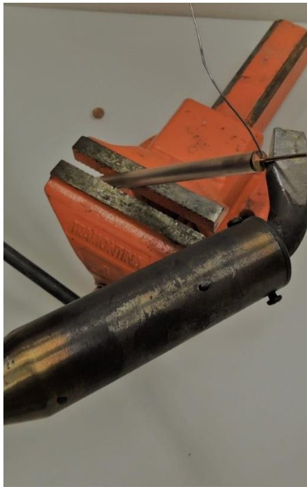
Fotografia 3 - Soldagem das tampas e do capilar
