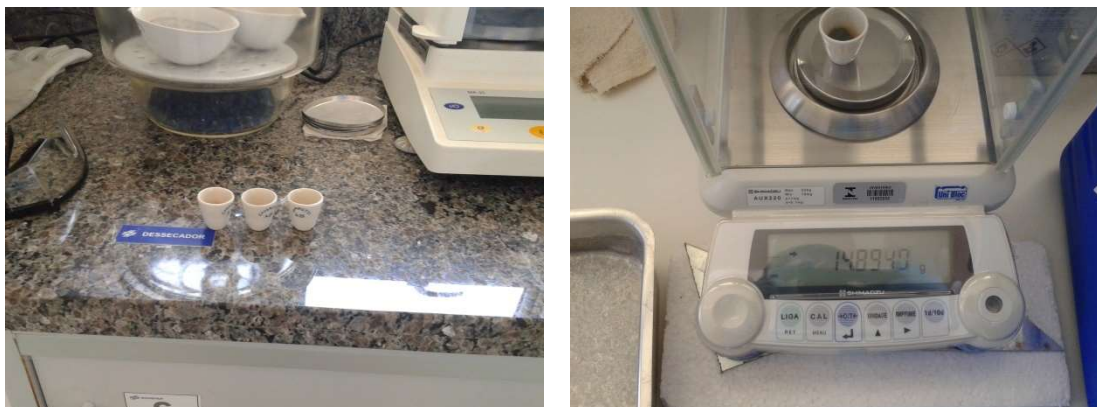
Figura 15 – Pesagem de material seco
