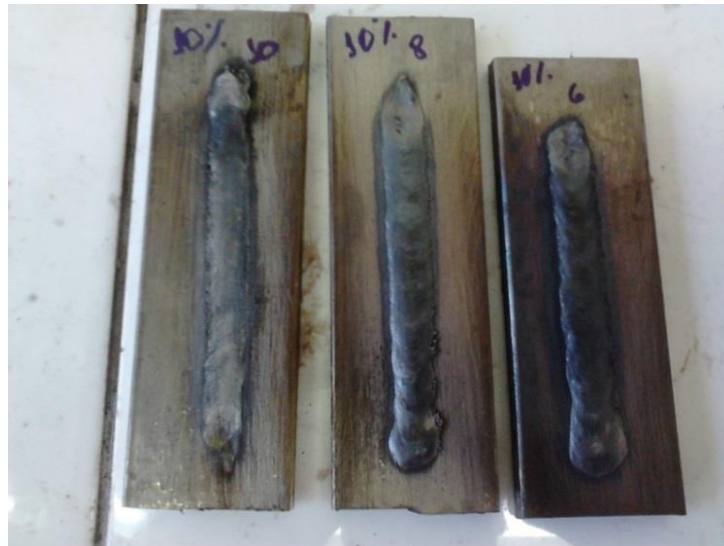
Figura 4.2 – Cordões Depositados com Diferentes Velocidades e com Composição de 10% de B_4C , Ampliação de 0.75 Fonte: Autoria Própria
