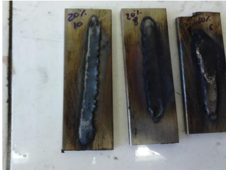
Figura 4.3 – Cordões com Diferentes Velocidades de Deposição e com 20% de B 4 C, Ampliação de 0,75
