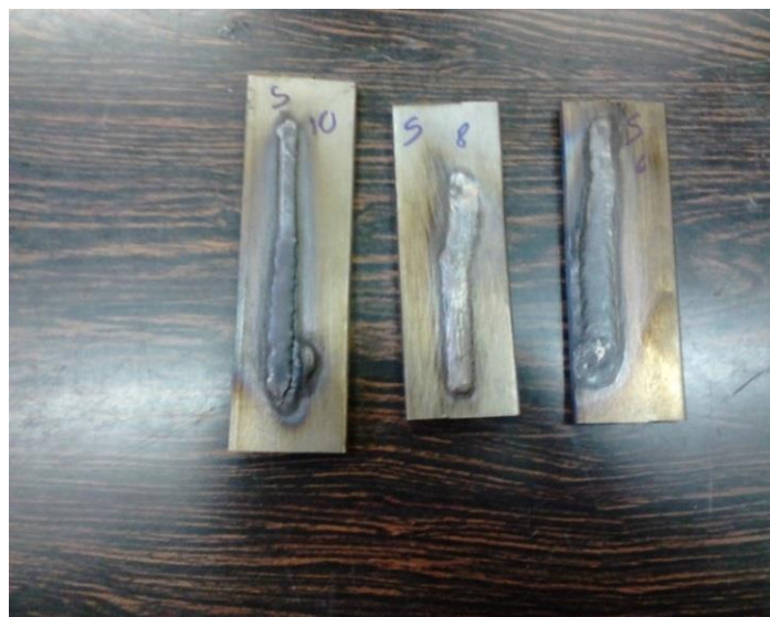
Figura 4.1 – Cordões com Diferentes Velocidades de Deposição e sem Adição de B_4C , Ampliação de 0.75
