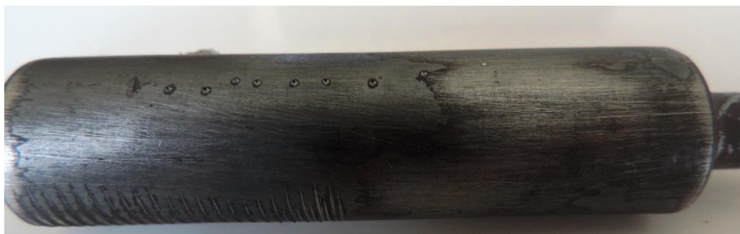
Figura 10 – Pontos de medição de Dureza Longitudinal Fonte: Autoria própria
