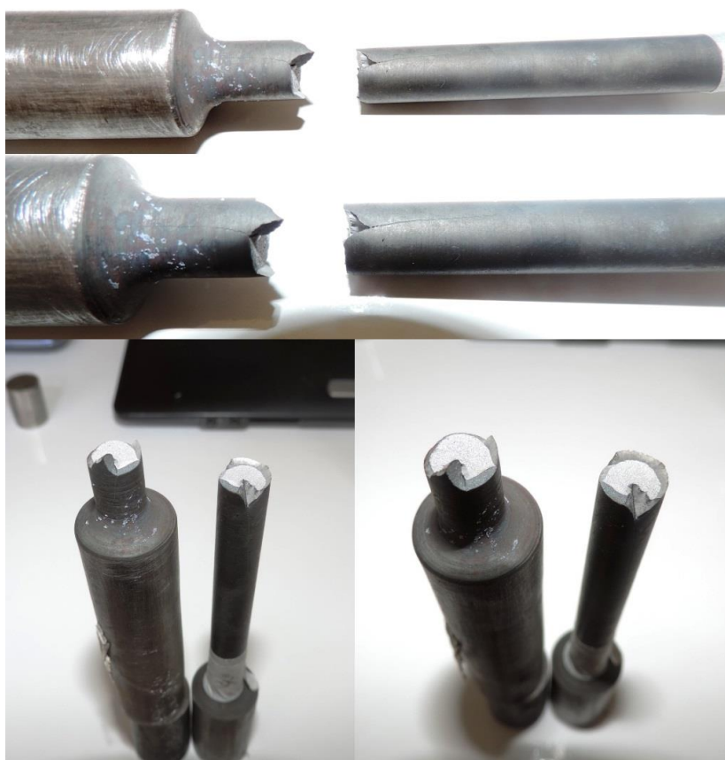
Figura 12 – Ruptura prematura do CP nº 4 devido trinca
