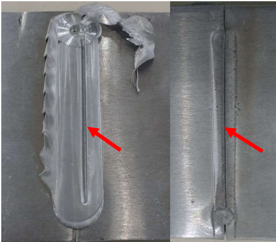
Figura 15: Junta soldada de alumínio 5052 H-34 com canal côncavo
