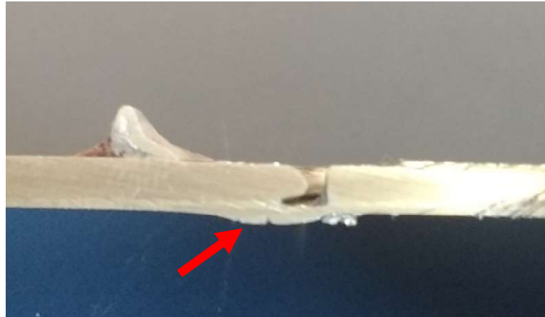
Figura 16: Vista em corte da junta de alumínio 5052-H34 com a presença do canal côncavo.
