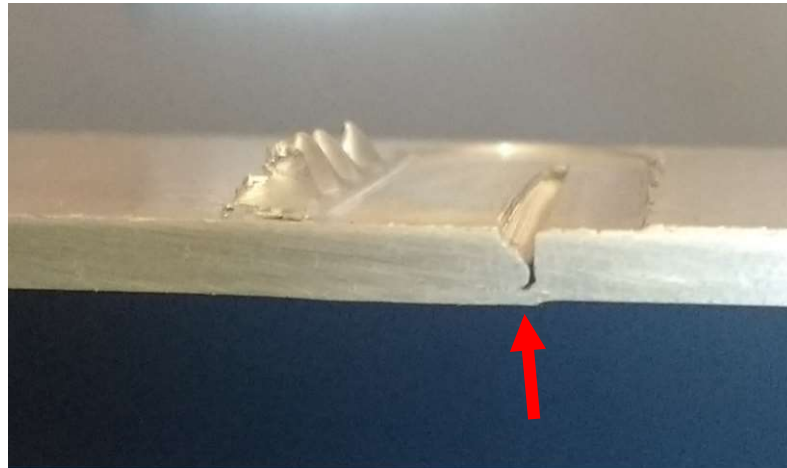
Figura 18: Corte da junta de alumínio 5052 H-34 soldada sem canal na mesa
