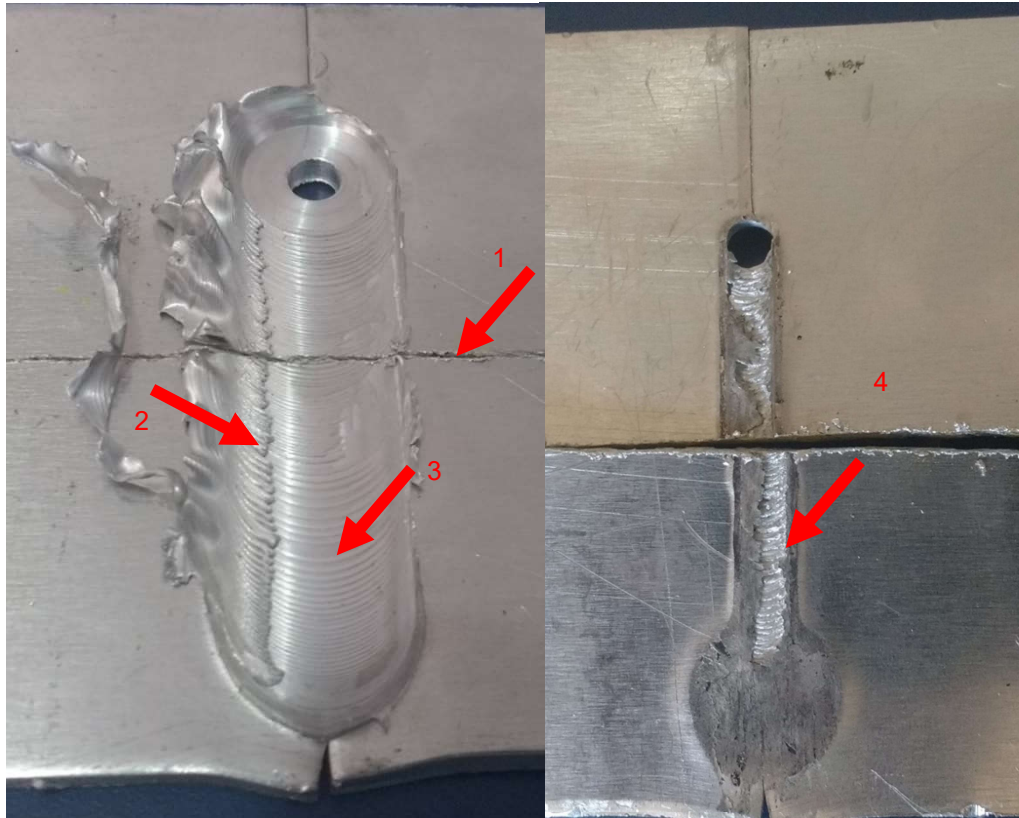
Figura 19: Junta da liga de alumínio 1200-H14 sem a presença de canal na mesa
