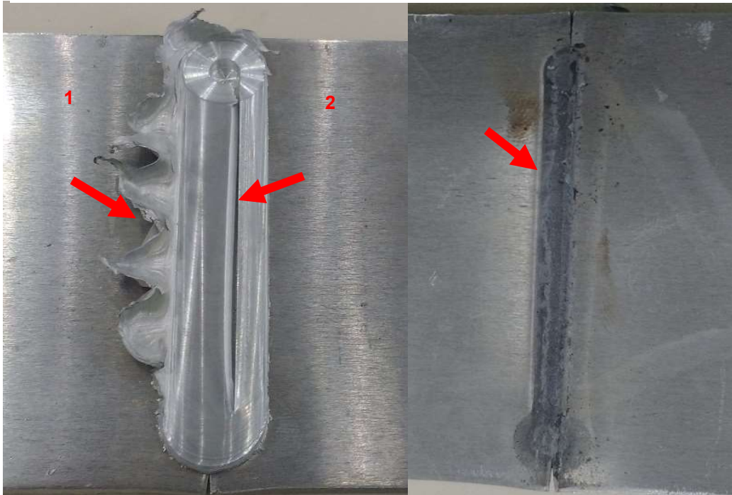
Figura 13: Junta soldada de alumínio 5052 H34 com canal retangular
