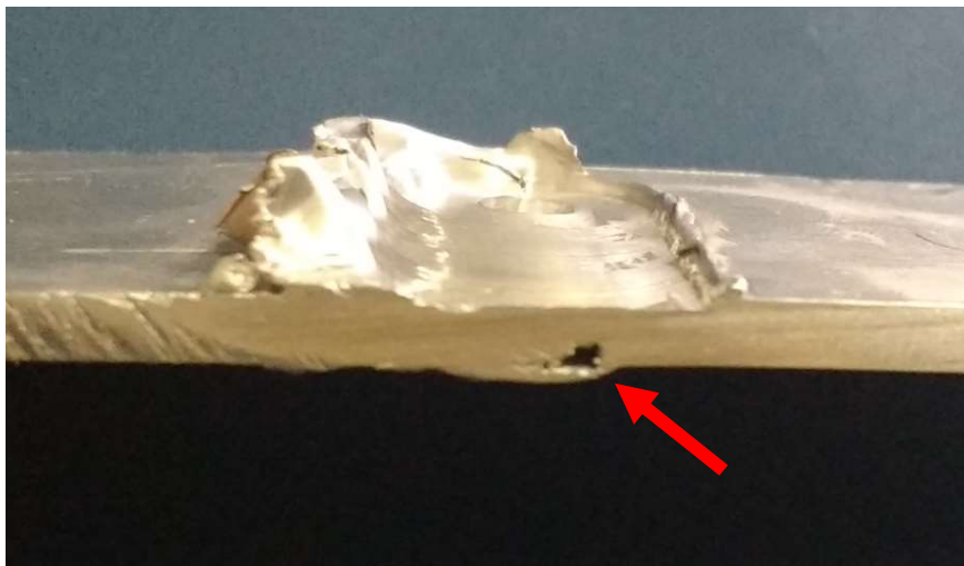
Figura 22: Corte da junta soldada de alumínio 1200-H14 com canal côncavo
