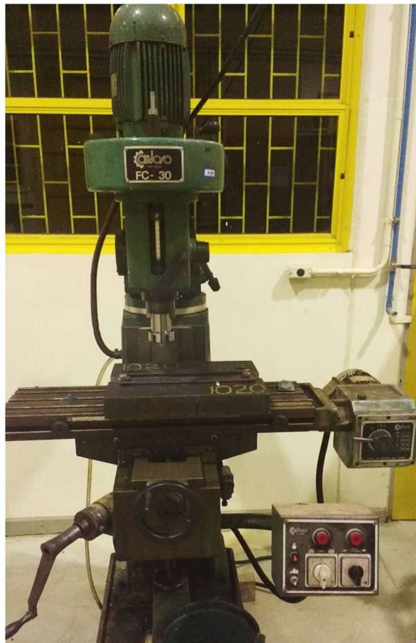
Figura 9: Fresadora Cardoso FC30 adaptada para realização de FSW
