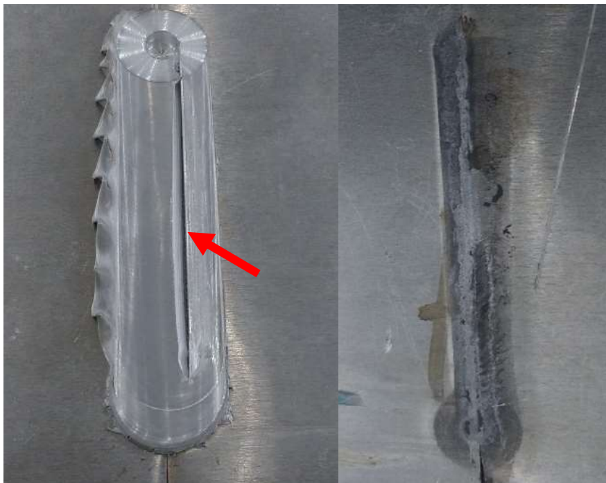
Figura 17: Junta de alumínio 5053 H-34 sem a presença do canal
