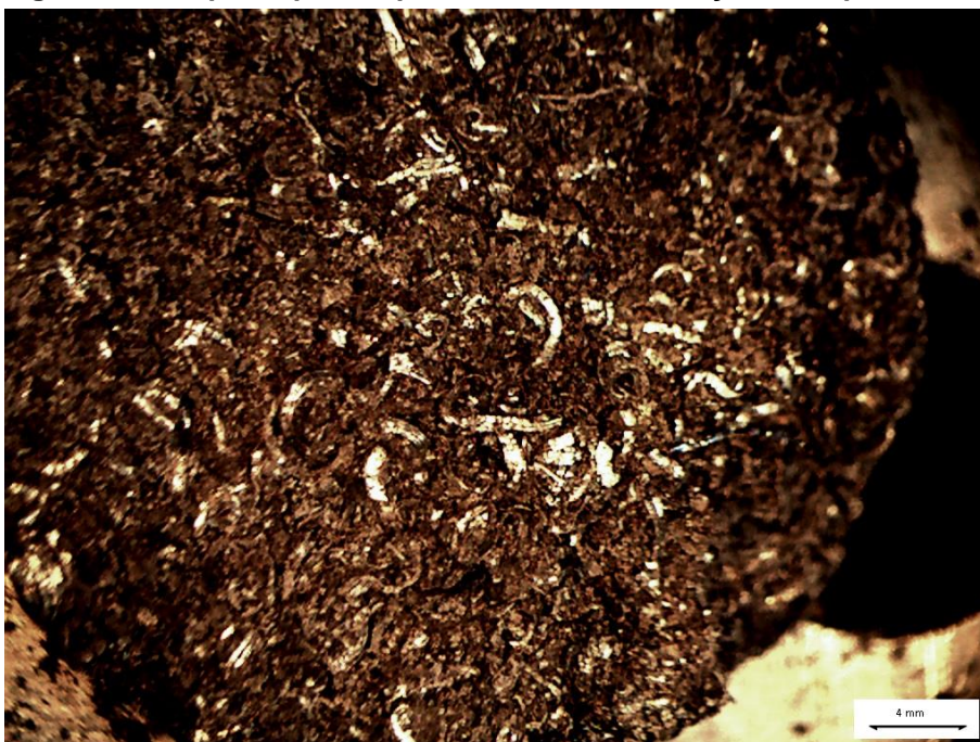
Figura 29 - Corpo de prova após a terceira sinterização a temperatura de 900 °C por uma hora.
