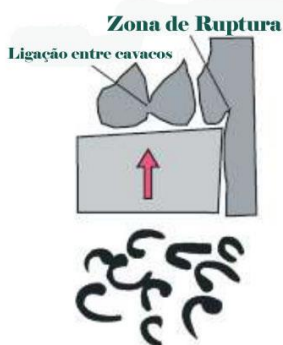
Figura 2 - Exemplificação de cavacos gerados por ruptura.
