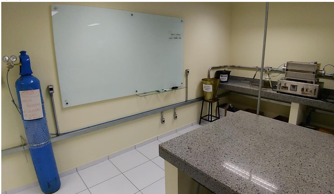
Figura 13 - Ilustração do sistema de ligação do cilindro de gás que fornece a atmosfera para o forno.
