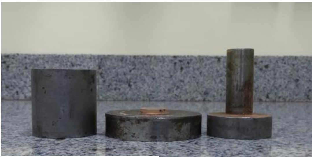
Figura 9 - Matriz utilizada no processo de compactação.
