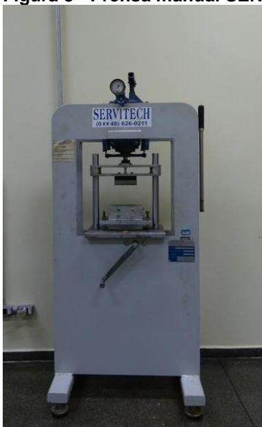
Figura 8 - Prensa manual SERVITECH com capacidade máxima de 30 toneladas.
