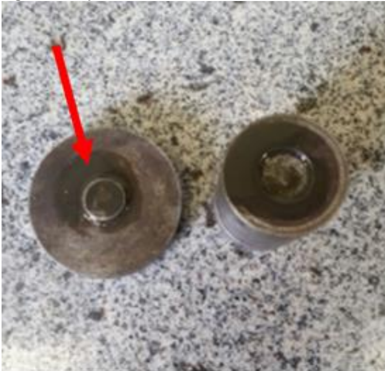
Figura 22 – Aparecimento de fluido de corte no momento da compactação.
