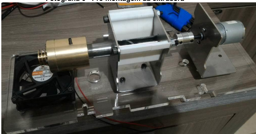
Fotografia 6 - Pré-montagem da extrusora
