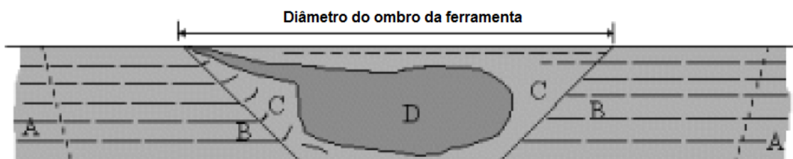
Figura 6 - Seção transversal de uma solda indicando as regiões afetadas pelo processo. FONTE: MISHRA E MAHONEY, 2007.
