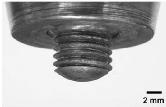
Figura 10 – Pino cilíndrico de fundo redondo com rosca esquerda FONTE: MISHRA e MAHONEY, 2007.
