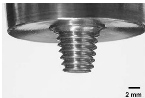
Figura 12 – Pino cônico com rosca esquerda. FONTE: MISHRA e MAHONEY, 2007.
