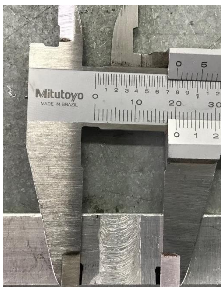
Figura 18 – Preparação da amostra para embutimento. FONTE: Autoria própria.
