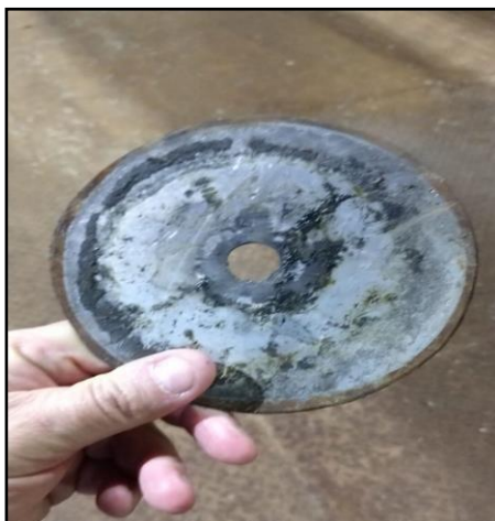
Figura 17 – Redução fixa no lugar do disco da válvula borboleta.
