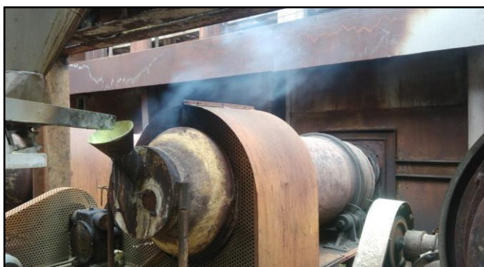
Figura 16 – Gás retornando na entrada do forno rotativo.
