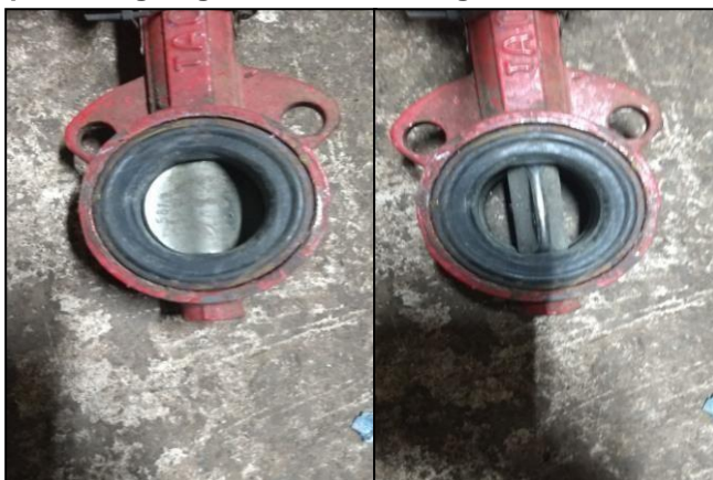
Figura 23 – Exemplo de uma válvula apropriada para a regulagem da vazão de água de resfriamento.
