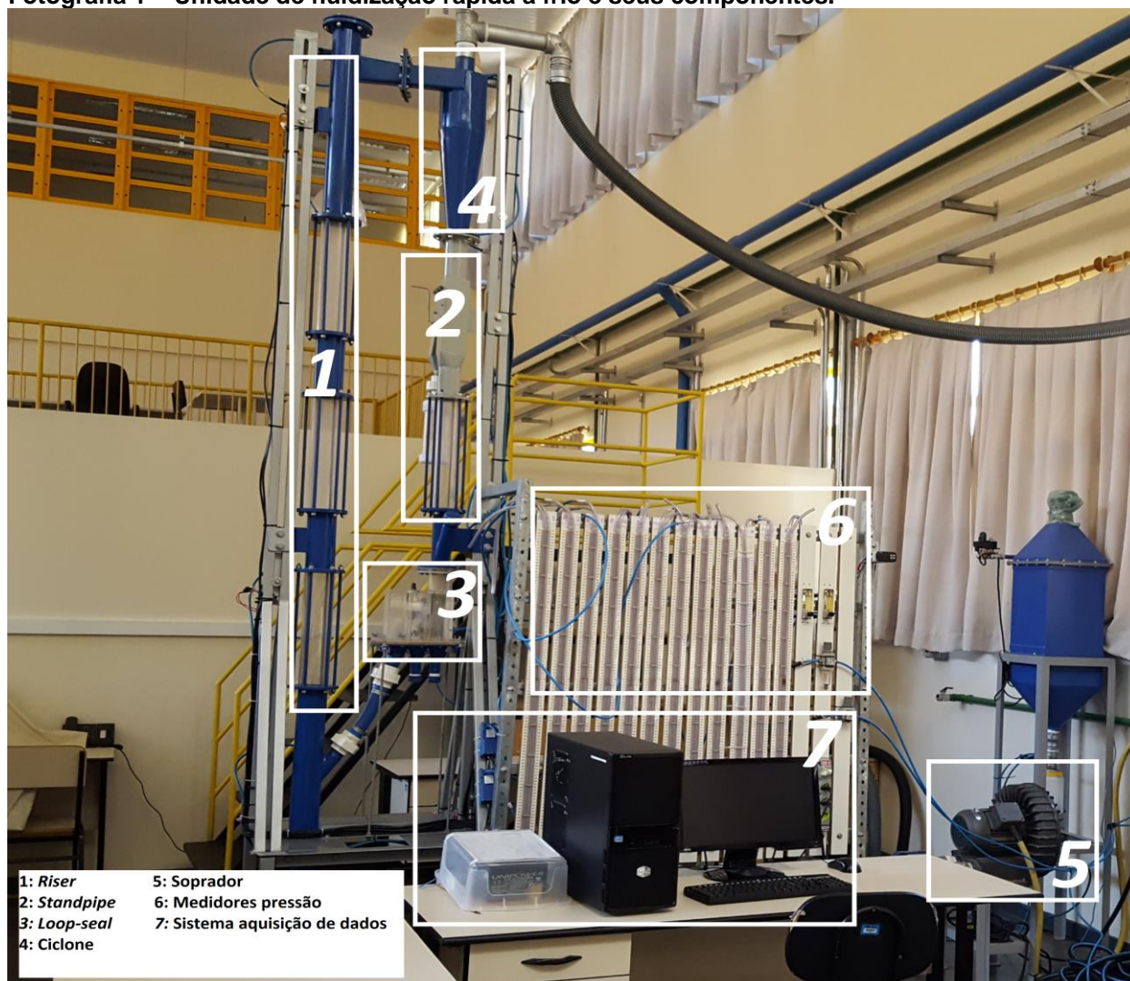
Fotografia 1 – Unidade de fluidização rápida a frio e seus componentes.
