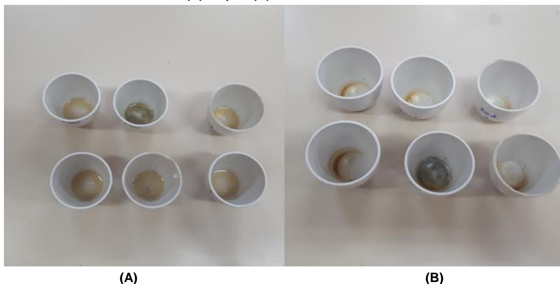
Figura 10 - Comparação dos cadinhos com a parte líquida das amostras da casca de soja antes (A) e após (B) a Gravimetria.
