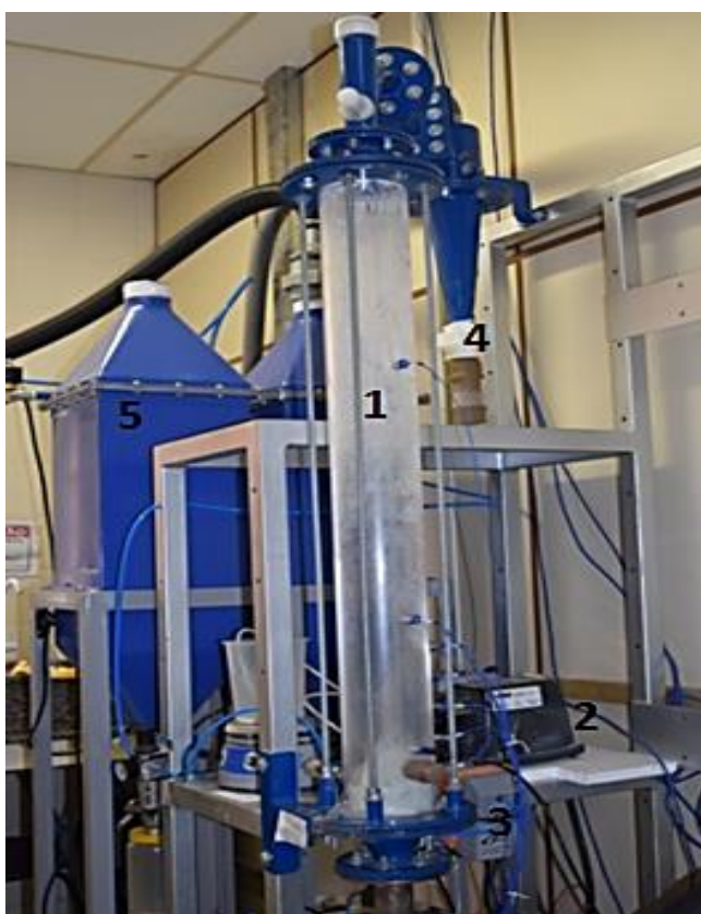
Fotografia 1 - Fotografia do sistema experimental. 1: coluna de fluidização; 2: bomba peristáltica; 3: transdutor de pressão; 4: ciclone; 5: filtro de mangas.
