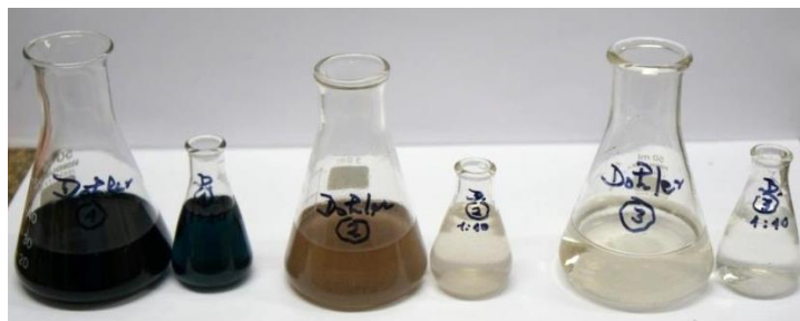
Figura 22 - Amostras de diferentes pontos do processo de tratamento do efluente de uma indústria têxtil
