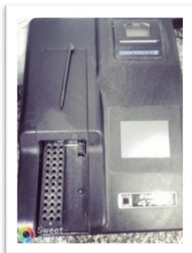
Figura 5 - Equipamento para leitura das amostras Stat Fax 4700 Awareness Technology Inc. com filtro de leitura 650nm.
