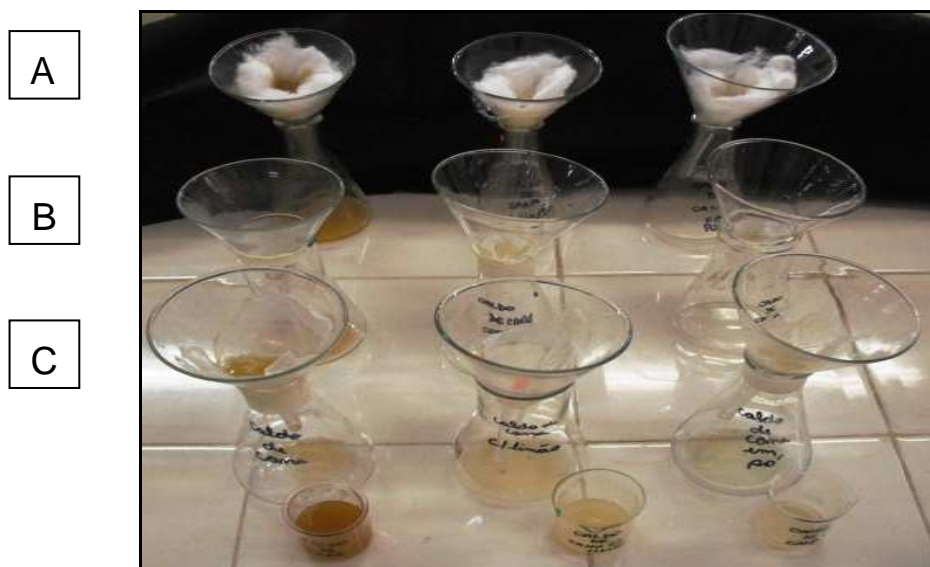
Fotografia 1 - Processo de filtração do caldo de cana: (A) Algodão; (B) Membrana de Éster Celulose; (C) Membrana de Celulose Bacteriana Fonte: Autoria Própria.
