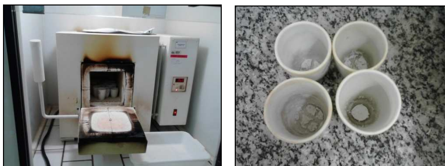
Fotografia 100 - Etapas da análise de cinzas: (A) Mufla; (B) Cadinho com cinzas Fonte: Autoria Própria.
