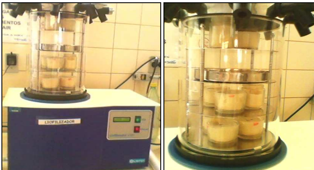
Fotografia 4 - Processo de liofilização da emulsão do caldo de cana Fonte: Autoria Própria.
