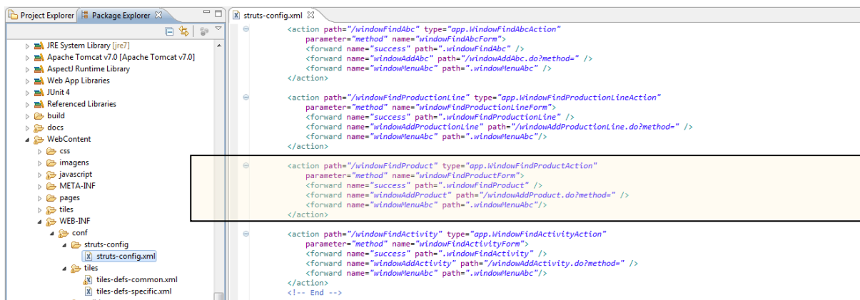
Figura 53 - Adição de uma Tag Action para WindowFindProduct . Fonte: Autoria Própria.
