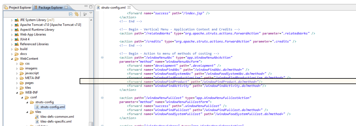
Figura 50 – Adição do forward para windowFindProduct sem método especificado. Fonte: Autoria Própria.
