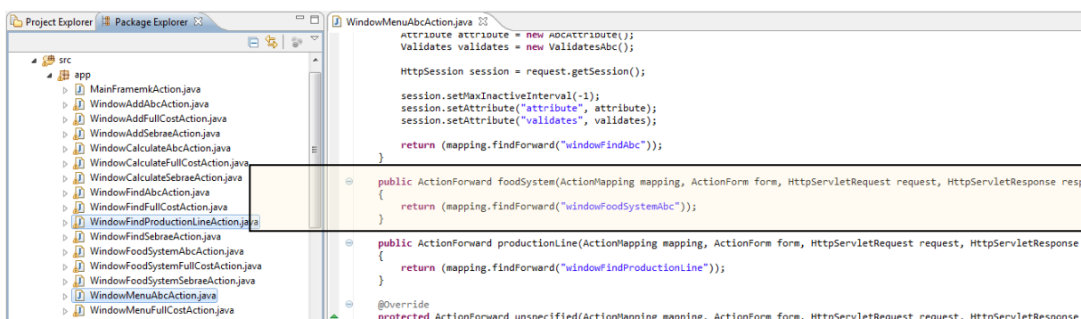
Figura 13 - Adição de método para redirecionamento de ProductionLine em windowMenuAbcAction . Fonte: Autoria Própria.
