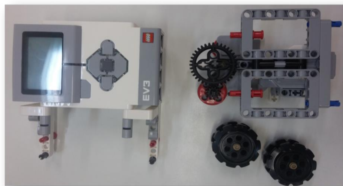
Figura 21 Montagem da base do robô e controlador do robô. Fonte: Própria.
