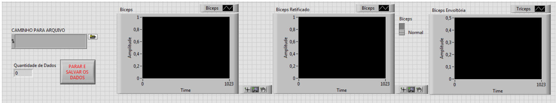
Figura B.2: Painel Frontal do programa de aquisição e salvamento de dados no LABVIEW TM Fonte: Autoria Própria
