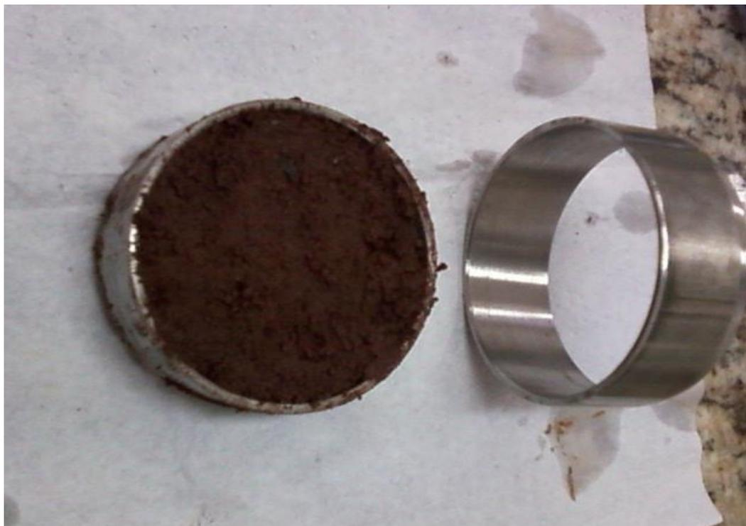
**Figura 2-** Amostra de solo em anel volumétrico para determinação de porosidade e densidade. UTFPR, Pato Branco -PR, 2015.
