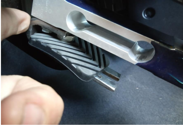
Figura 33: ETAPA 2 (Instalação da pedaleira do equipamento no pedal veículo).
