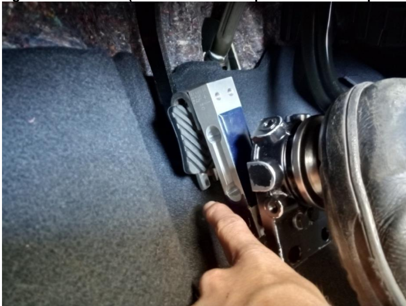
Figura 40: ETAPA 8 (Soltar levemente o pedal eliminando pré-carga excessiva).
