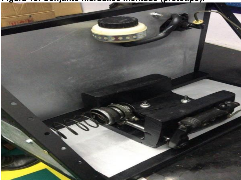
Figura 18: Conjunto hidráulico montado (protótipo).
