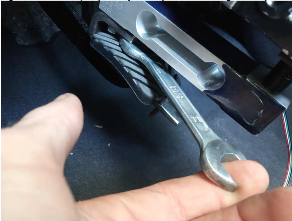
Figura 35: ETAPA 4 (Torque de ajuste no pedal da embreagem com pedaleira).
