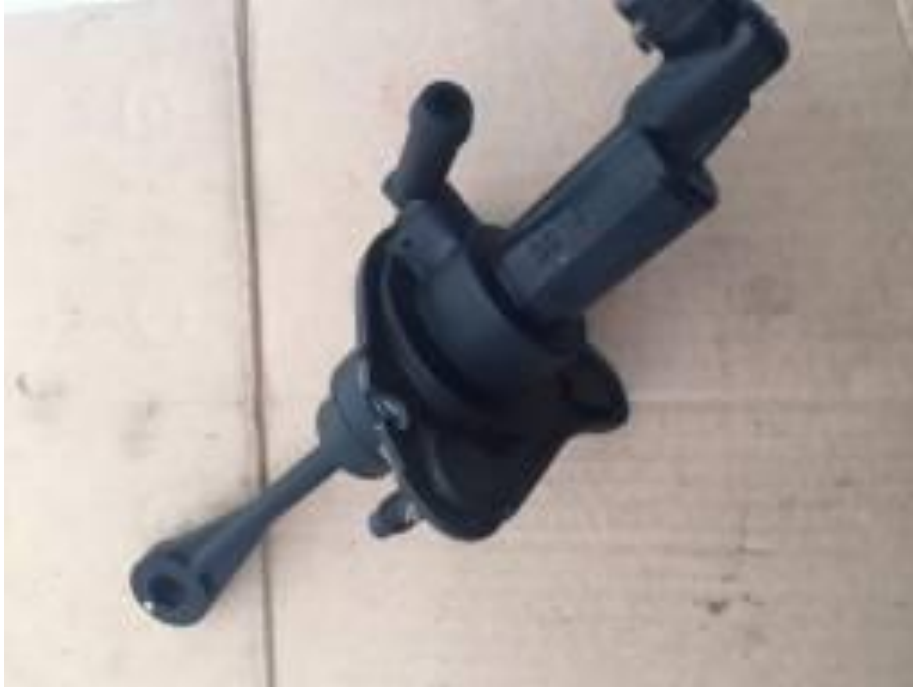
Figura 14: Cilindro mestre acionamento de embreagem utilizado.
