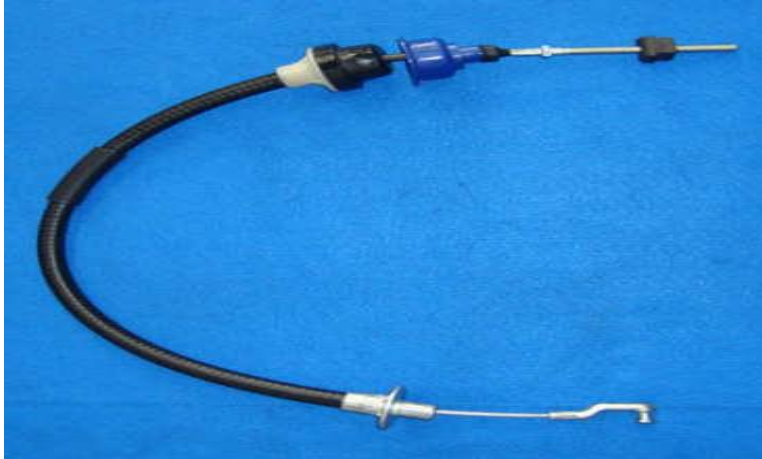
Figura 6: Cabo de embreagem (acionamento mecânico).
