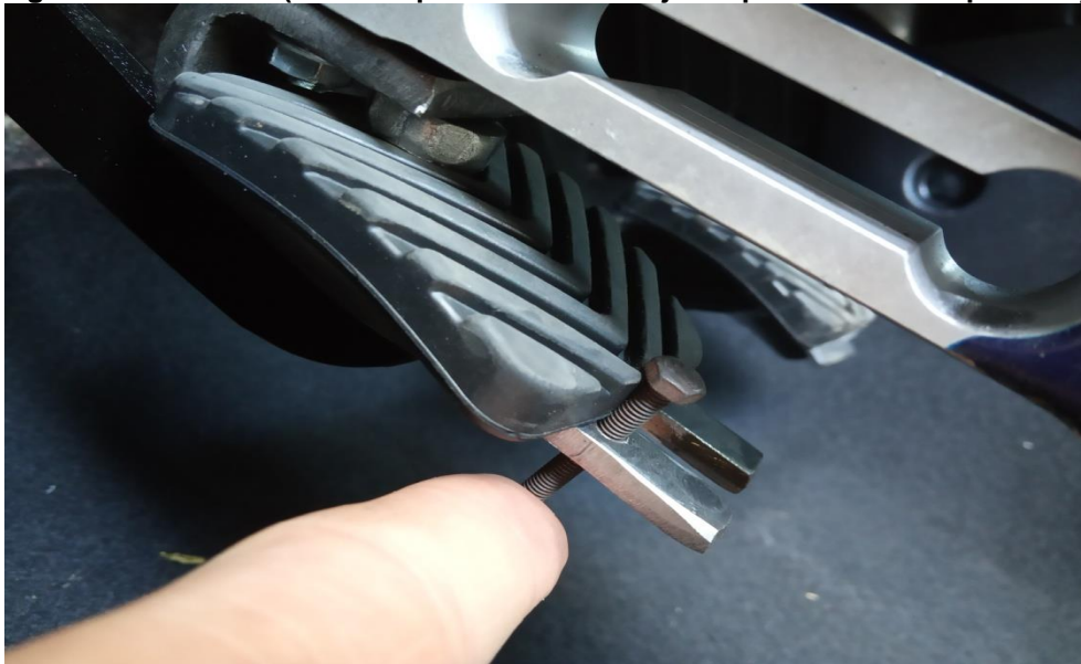
Figura 34: ETAPA 3 (Inserir o pino trava do conjunto pedaleira do dispositivo).
