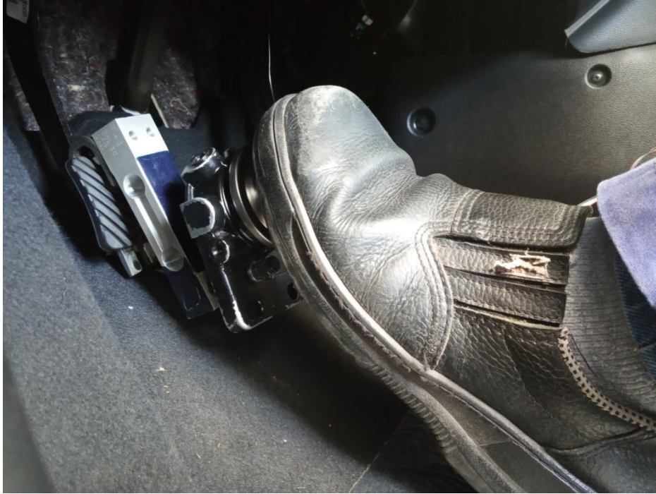
Figura 39: ETAPA 7 (Pressionar o pedal de embreagem totalmente).
