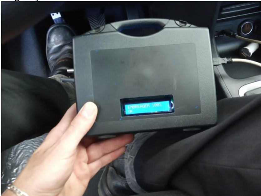
Figura 42: ETAPA 10 (Interpretação do valor medido, mensagem do percentual de desgaste).
