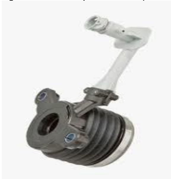
Figura 10: Cilindros tipo concêntrico (acionamento hidráulico).
