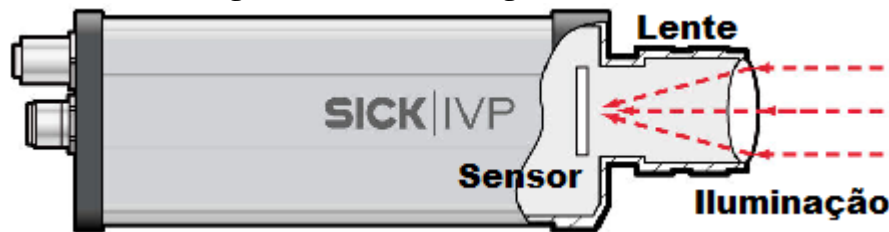
Figura 3: Sensor de imagem na câmera
