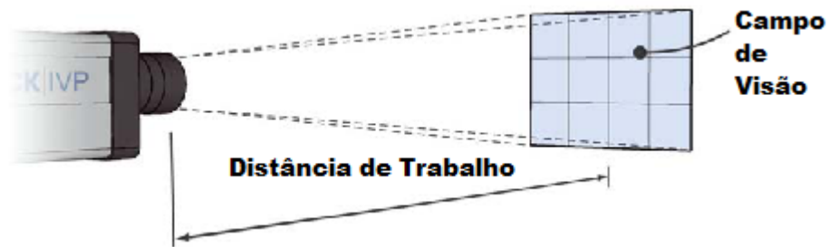
Figura 9: Distância de trabalho e campo de visão
