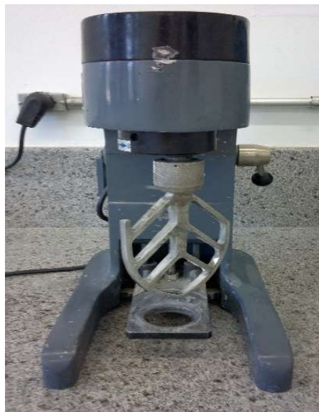
Figura 13 - Misturador mecânico sem a cuba Fonte: Autoria própria.
