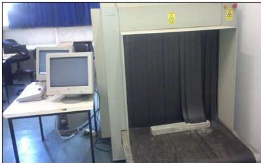
Figura 17 - Equipamento de raios X para a análise da porosidade das amostras Fonte: Autoria própria.
