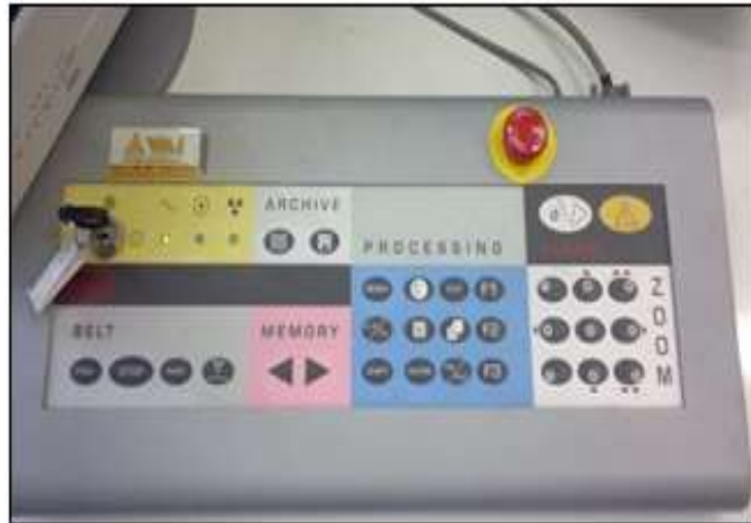
Figura 18 - Painel de comando do equipamento de raios X Fonte: Aatoria própria.
