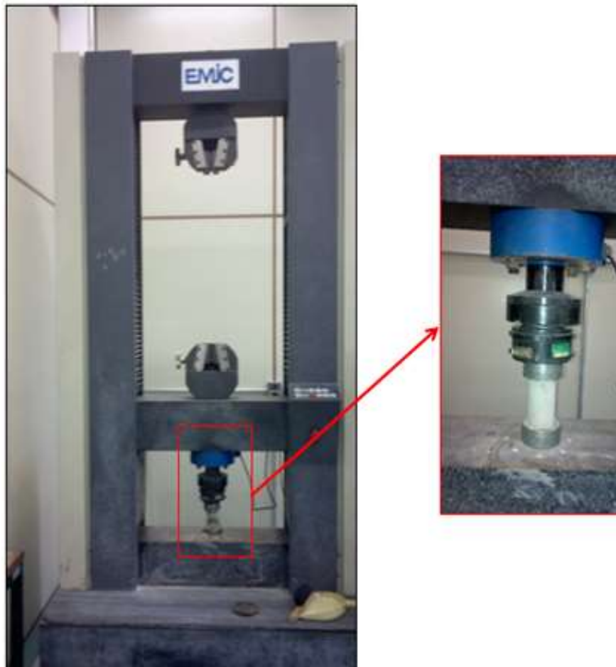
Figura 16 - Ensaio de resistência à compressão do corpo de prova Fonte: Autoria própria.
