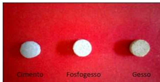
Figura 19 - Pastilhas de argamassa de cimento Portland, fosfogesso e gesso natural Fonte: Autoria própria.
