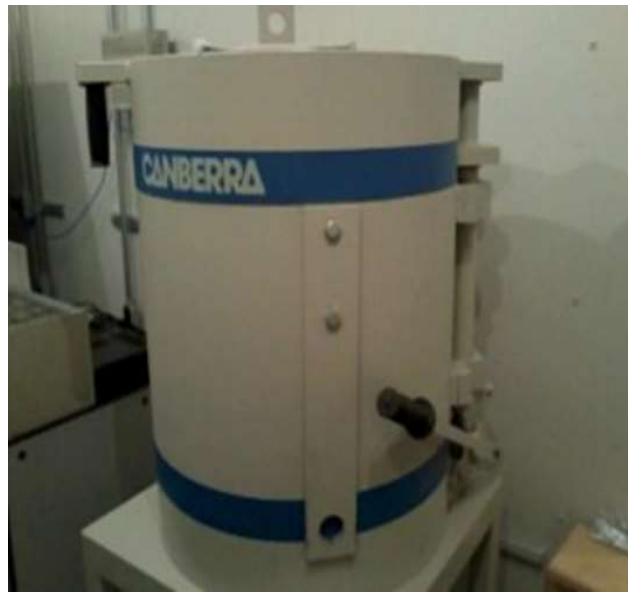
Figura 23 - Espectrômetro gama localizado no CDTN Fonte: Del Claro (2013).
