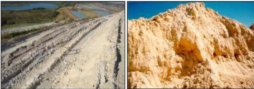
Figura 8 - Armazenamento de pilhas de fosfógeno à céu aberto Fonte: Costa (2011).
