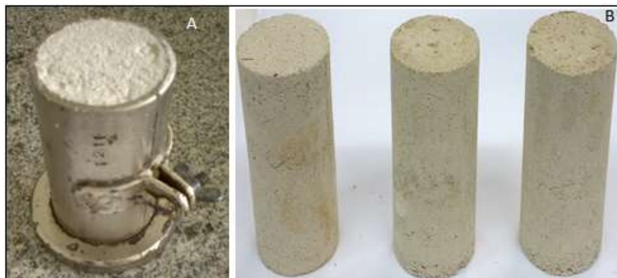
Figura 15 - Argamassa de fosfogesso no molde (A) e corpos de prova de fosfogesso (B) Fonte: Autoria própria.
