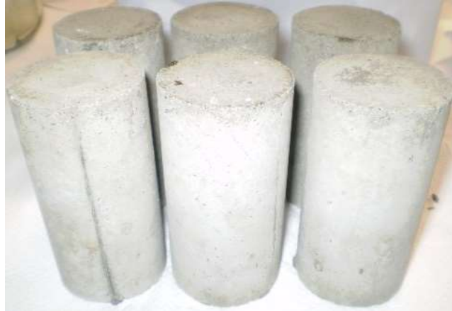
Figura 14 - Corpos de prova de cimento Portland Fonte: Autoria própria.
