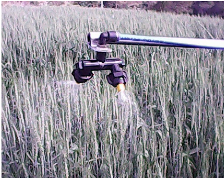
Figura 2 - Pontas duplo-leque, com ângulos de 30^\circ direcionados para frente e 70^\circ para trás.
