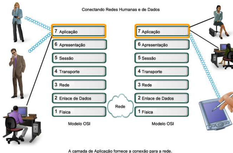
Figura 3: Comunicação em Camadas e Modelo OSI
