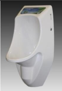
Características Técnicas:<br>Mictório Urimat ou similar, que não utiliza água ou produtos químicos, confeccionado em molde injetado de policarbonato, com superfície livre de poros e formato que previne depósito e desenvolvimento de odores, e redução de respingos. |
