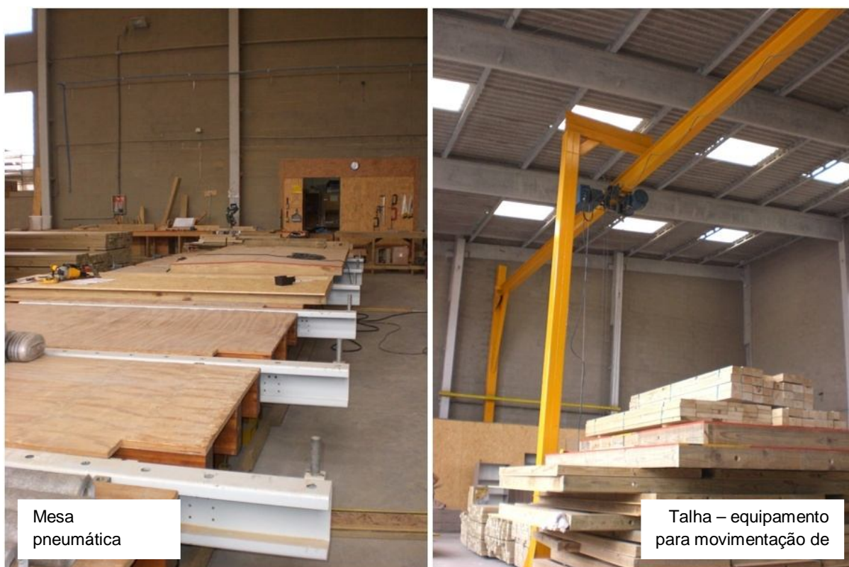
Figura 19 – Mesa pneumática para produção dos painéis e equipamento utilizado para movimentação (talha)
