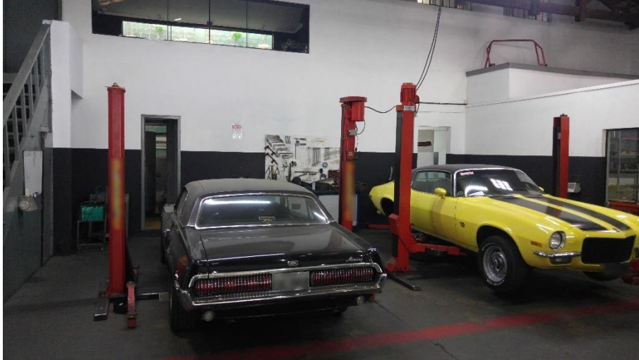
Figura 8: Elevadores da Oficina 3.
