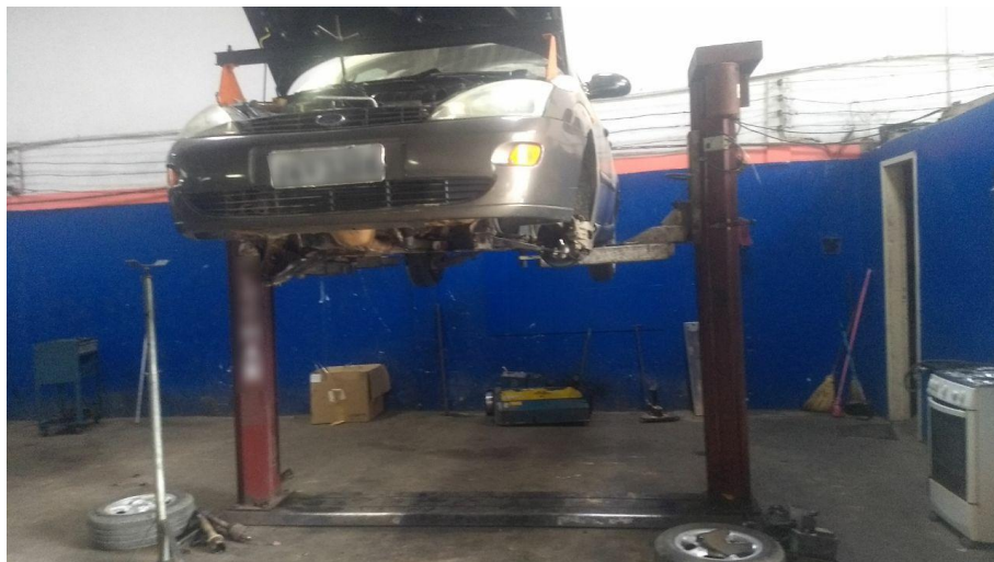
Figura 10: Elevador mal conservado da Oficina 1.
