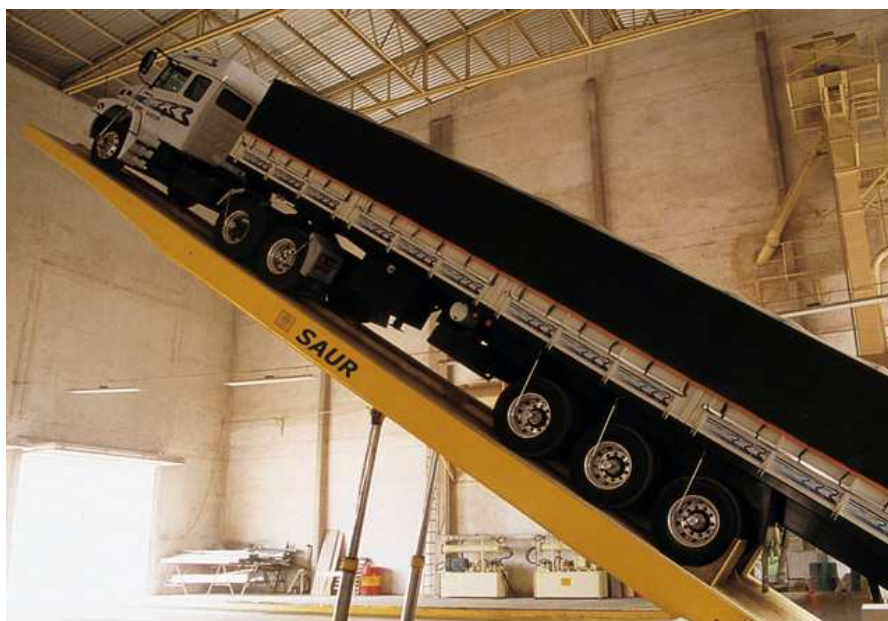
Figura 5 – Plataforma elevatória para descarga de caminhões Fonte: SAUR (2016).
