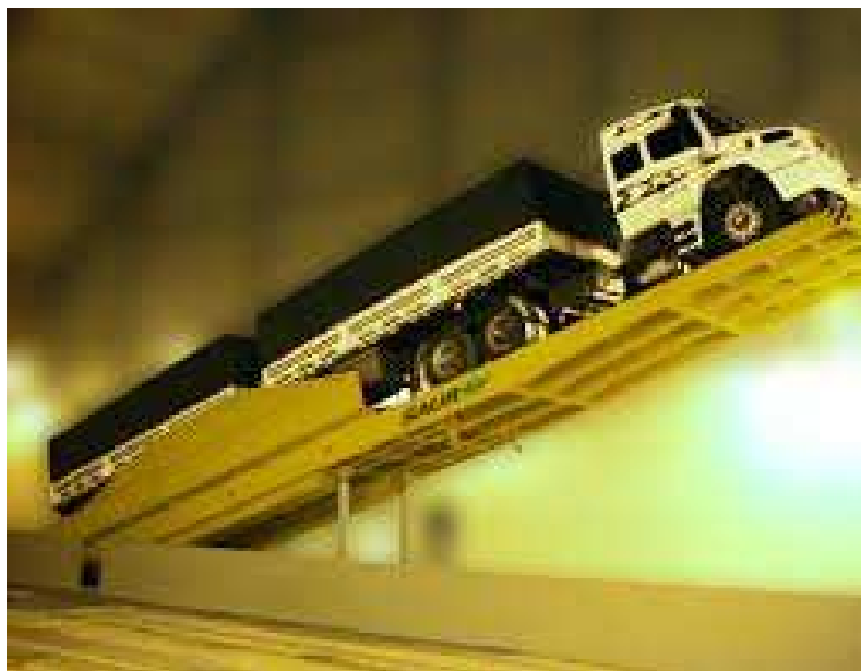
Figura 4 – Plataforma elevatória para descarga de caminhões Fonte: SAUR (2016)
