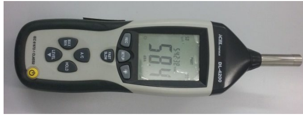
Figura 10. Medidor de nível de pressão sonora Akso. Fonte: Próprio Autor (2018).
