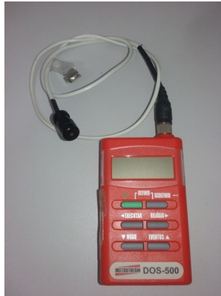
Figura 9. Audiodosímetro modelo Instrutherm DOS-500. Fonte: Próprio Autor (2018).
