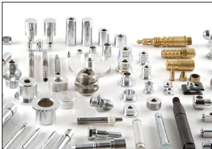
Figura 2.3 – Exemplo de peças usinadas em torno. (Fonte: Grupo Tecnofix, 2019)
