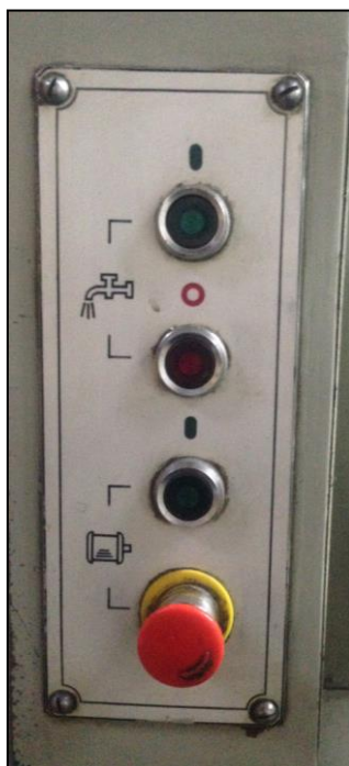
Figura 4.3 – Botão de emergência localizado na face frontal do cabeçote fixo do torno (Fonte: Do autor)
