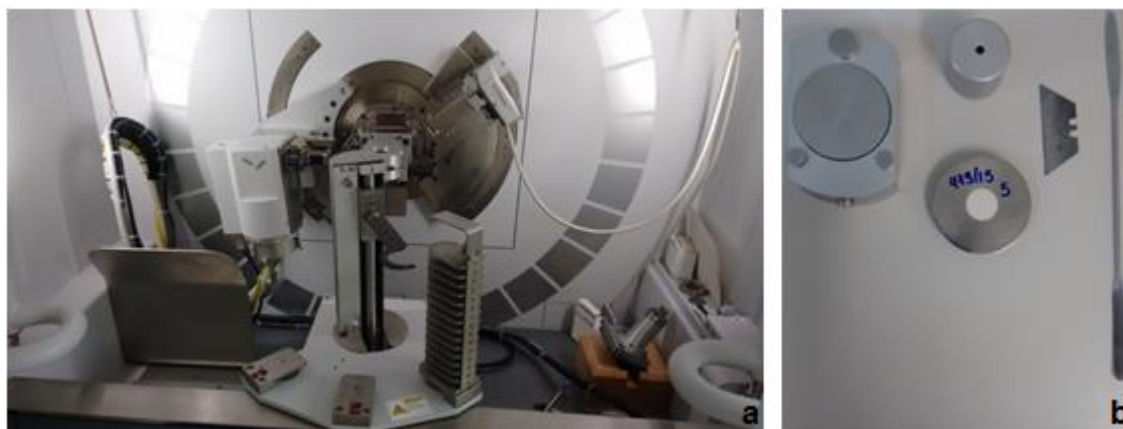
Figura 22 - a) Equipamento de DRX; b) Aparatos utilizados no preparo de amostras para análise de DRX Fonte: Pessoal.
