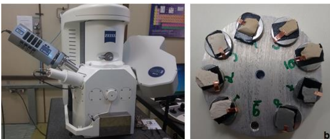
Figura 25 - a) Equipamento de MEV e b) porta amostra pronto para análise Fonte: Pessoal.
