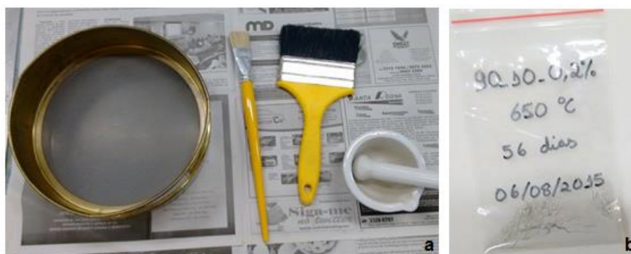
Figura 21 - a) Aparatos utilizados na preparação da amostra e, b) amostra tritura pronta para análise
