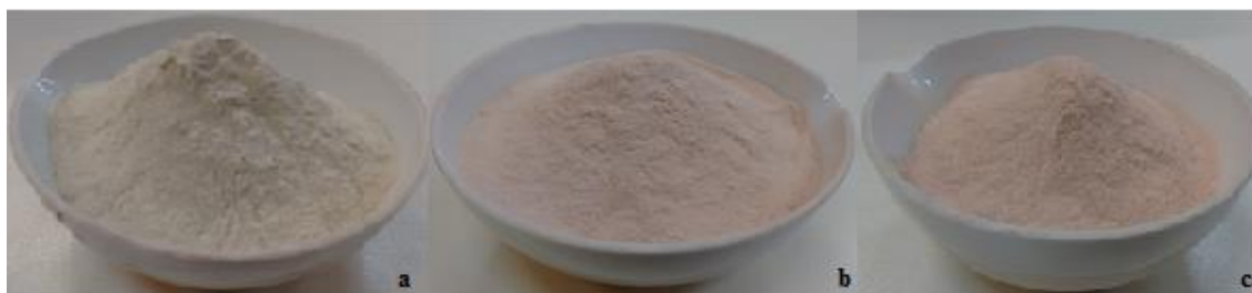
Figura 15 - a) Fosfogesso in natura , b) calcinado à 350 °C e c) calcinado à 650 °C Fonte: Pessoal.
