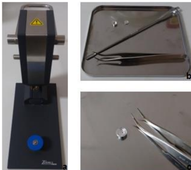
Figura 24 - a) prensa e b) aparatos utilizados no preparo das amostras; c) cadinho pronto para análise de DSC Fonte: Pessoal.
