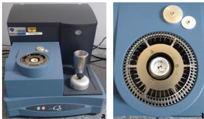
Figura 23 - a) equipamento de DSC e b) forno do DSC Fonte: Pessoal.
