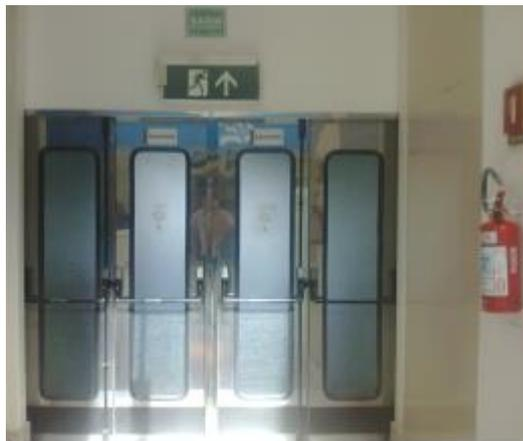
**Figura 17 – Exemplo de saída de Emergência com sinalização adequada e barra antipânico**
