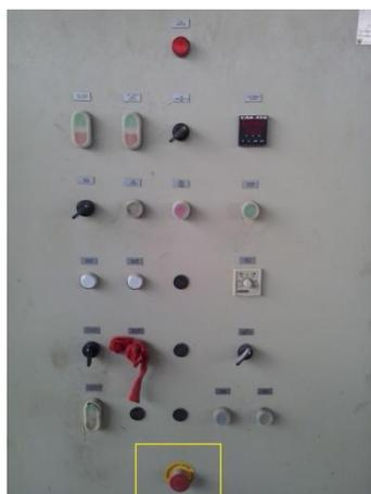
**Figura 23 – Dispositivo de parada de emergência da máquina 1.**
