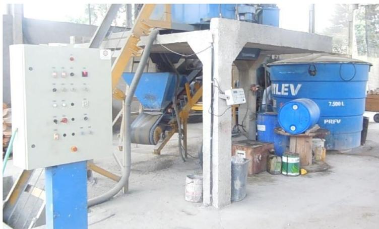
**Figura 20 – Partes móveis da máquina 1 sem proteção.**
