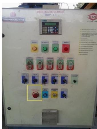
Figura 24 - Dispositivo de parada de emergência da máquina 2.
