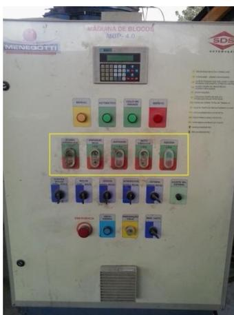
**Figura 19 - Dispositivos de partida e parada da máquina 2.**
