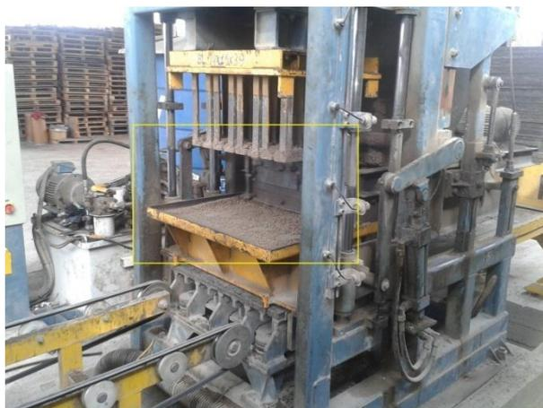
**Figura 22 – Partes móveis da máquina 2 sem proteção adequada.**
