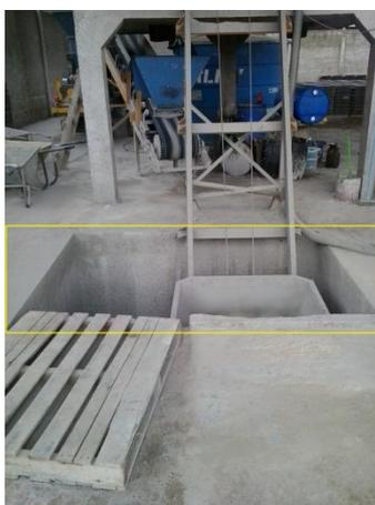
**Figura 21 – Risco de queda na área de alimentação da máquina 1.**
