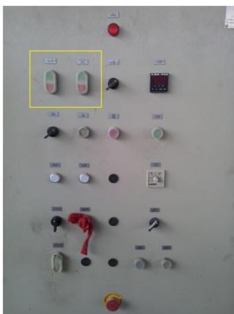
**Figura 18 – Dispositivos de partida e parada da máquina 1.**
