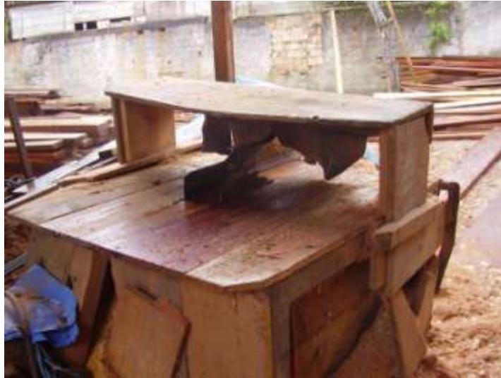
Figura 13- Serra com proteção improvisada
