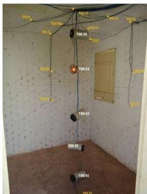
Figura 18 – Célula-teste com diversos sensores internos de temperaturas.
