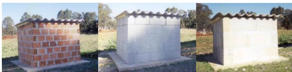
Figura 16 – Células-teste de diferentes materiais. Fonte: (KRÜGER et al. , 2004)
