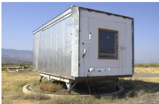
Figura 14 – Célula-teste utilizada em estudos na Espanha.
