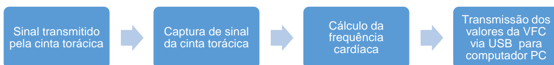
Figura 3 – Fluxograma módulo do hardware
