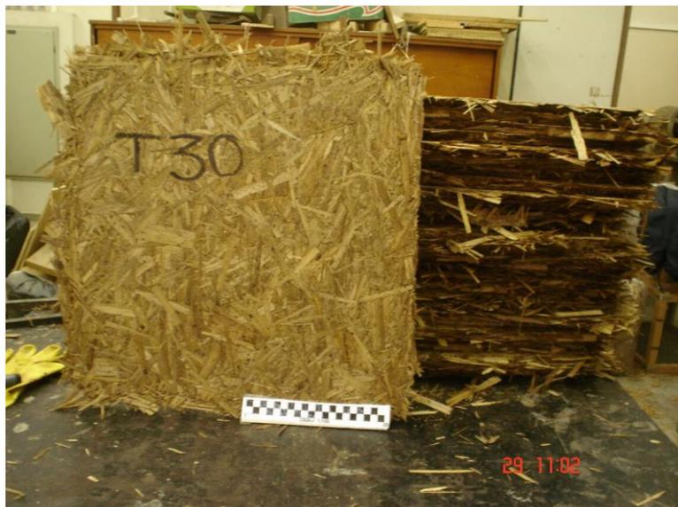
Figura 3.12 – Paineis tipo OSB com bambu *D.giganteus* já consolidado. Foto do Autor.
