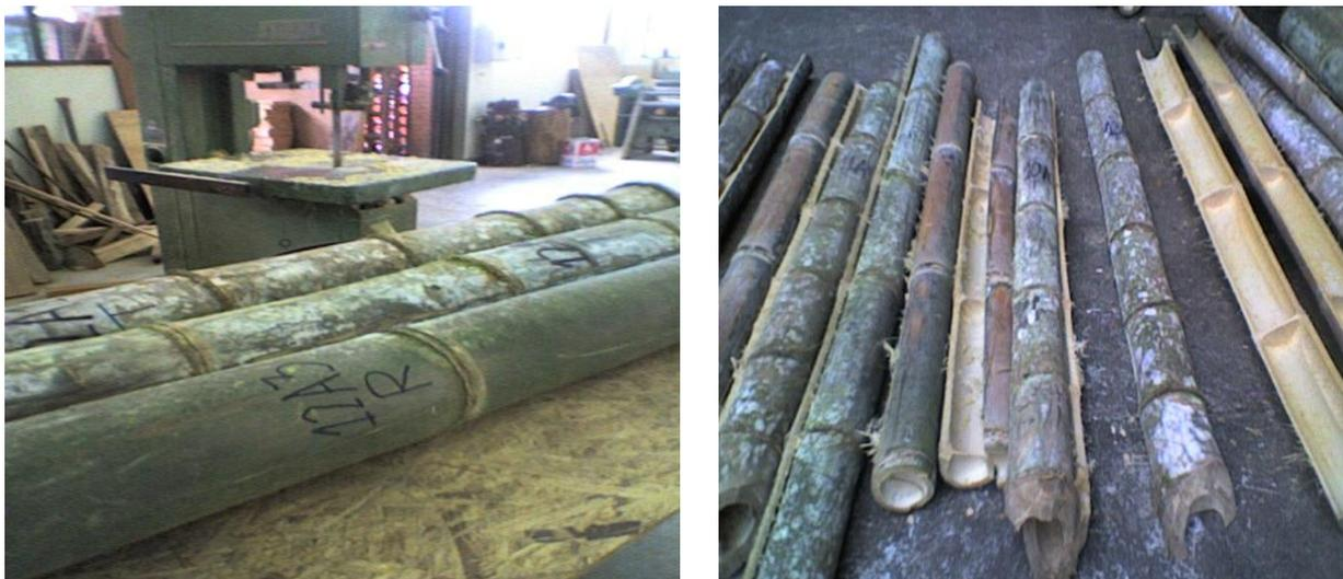
Figura 3.8 – Antes e após o corte longitudinal. Foto do Autor.
