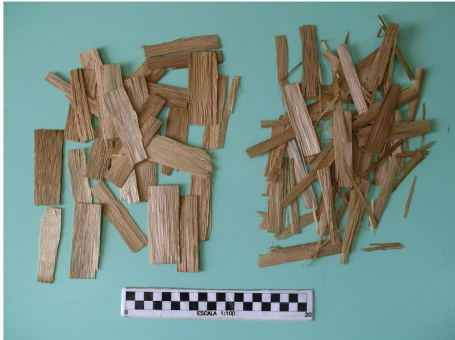
Figura 3.10 – Partículas oriundas do corte tangencial, à esquerda, e radial, à direita. Foto do Autor.
