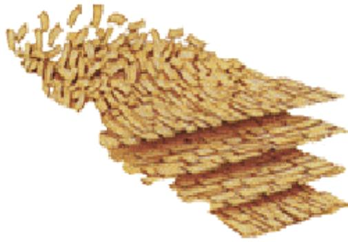
Figura 2.10 – Orientações das partículas de madeiras ou fibras vegetais em painéis de Oriented Strandboard (Fonte: MASISA)
