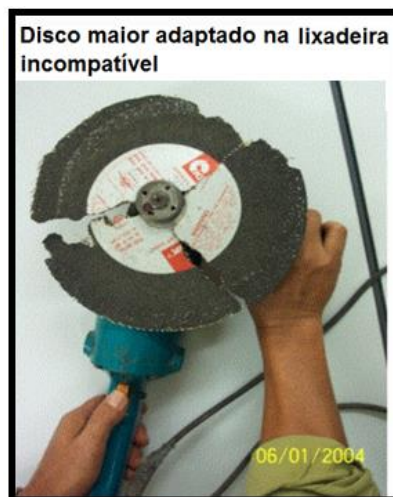
Figura 22 Disco maior adaptado na lixadeira incompatível. Fonte: Navarro, 2018
