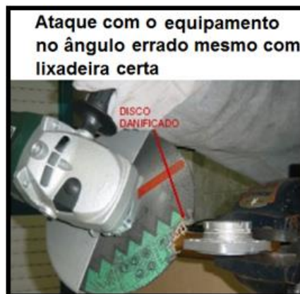
Figura 23 Ataque com o equipamento no ângulo errado mesmo com lixadeira certa Fonte: Navarro, 2018
