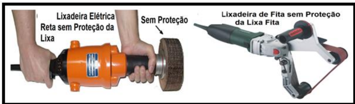
Figura 17: Lixadeira reta sem proteção da lixa e lixadeira de fita sem proteção da lixa fita
