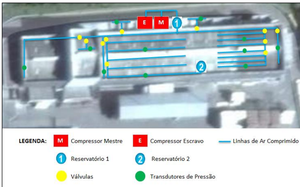
Figura 15 – Localização das válvulas e transdutores de pressão
