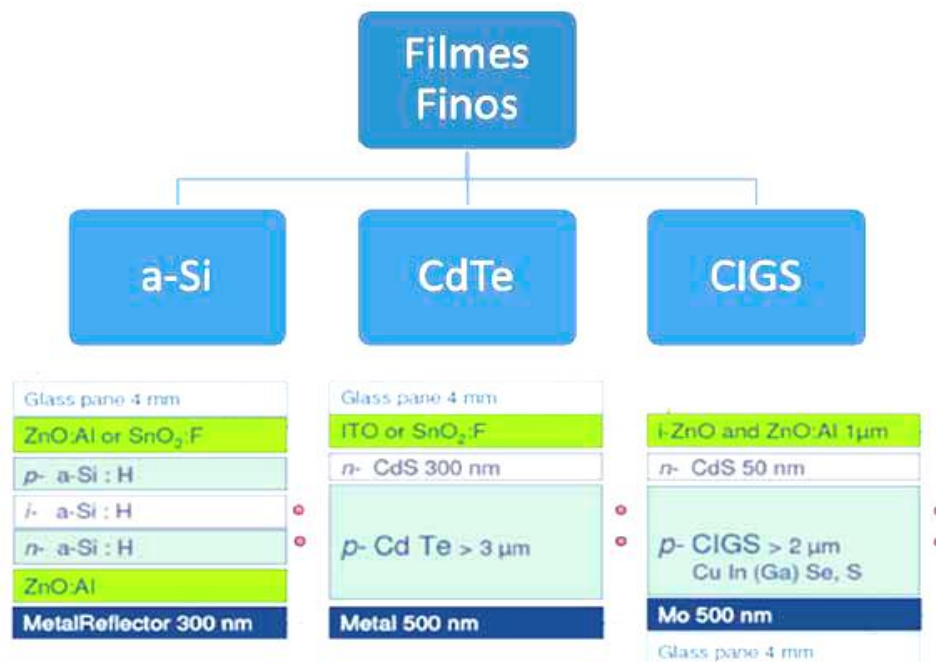
Figura 19 – Estrutura Sólida da Célula de Filme Fino Fonte: ABINEE (2012).
