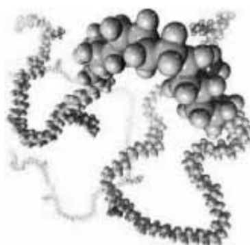
Figura 16: Representação esquemática da estrutura do PEBD.
