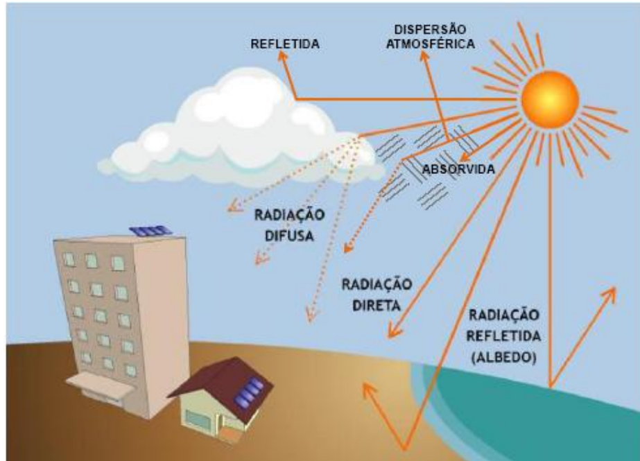
Figura 2: Imagem com a representação das componentes da radiação solar Fonte: TIEPOLO (2015).
