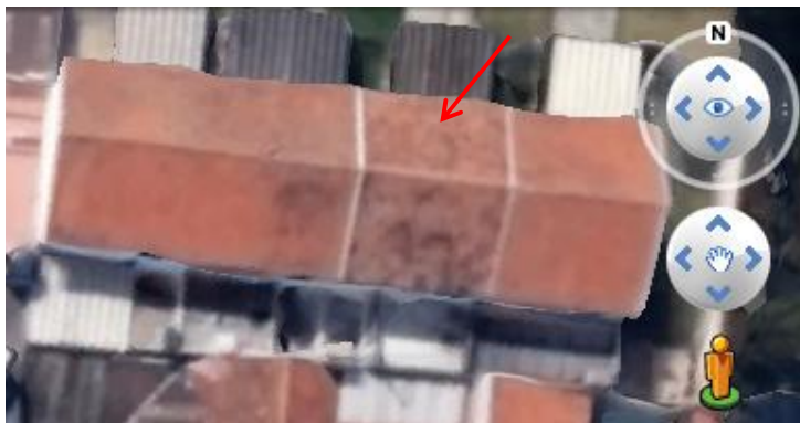
Figura 13: Telhado voltado próximo ao norte geográfico e sem sombreamento em sua área, com inclinação próxima a latitude do local. Fonte: Adaptado de Google Earth (2016).
