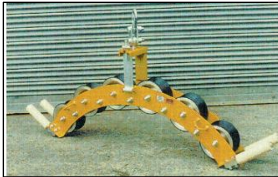
Figura 17 - Dispositivo para lançamento em estruturas em ângulo superior a 60° Fonte: Adaptado de Furukawa (2014).
