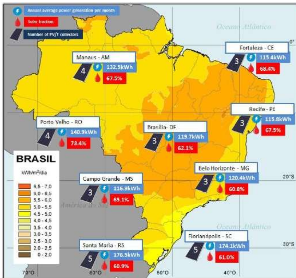
Figura 40 - Quantidade de módulos fotovoltaicos híbridos necessários para atingir 60% de fração solar por região do Brasil
