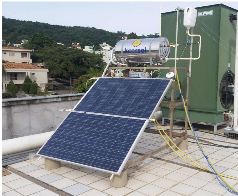
Figura 35 - Bancada de Teste - Coletor Fotovoltaico Térmico
