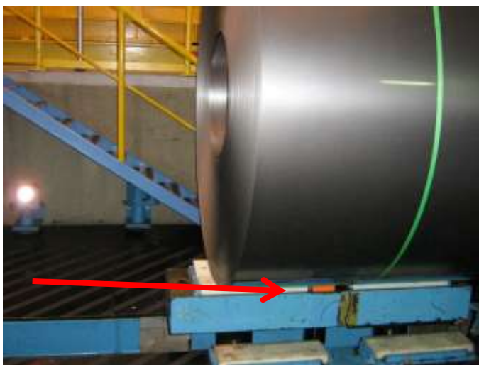
Figura 4.1 - Sensor de Indicação de Presença de Bobina
