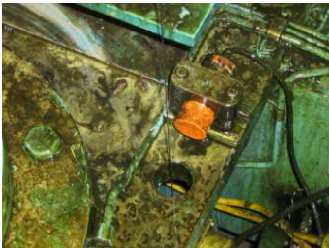
Figura 4.2 – Sensor de Indicação de Carro na Posição Baixa
