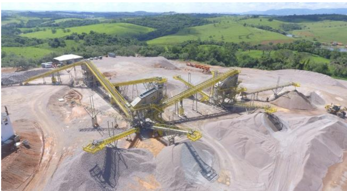
Figura 3 – Exemplo de Planta de Peneiramento
